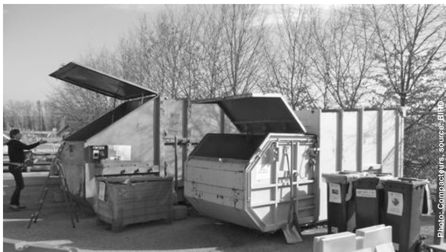
Certaines déchèteries communales (ici Echichens, VD) disposent de compacteurs pour cartons et pour plastiques durs, ce qui permet de diminuer les transports.
