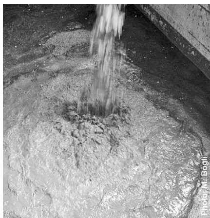
Boues de dépotoirs de routes avant traitement.
