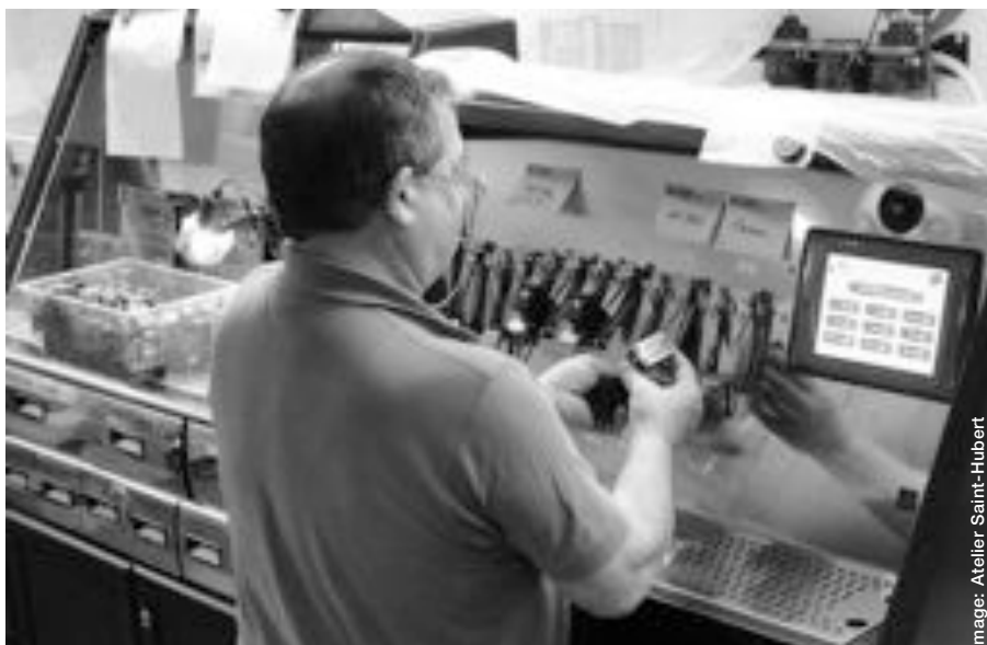
Reconditionnement des cartouches à l'atelier Saint-Hubert: remplissage (à gauche) et test des cartouches (à droite).
