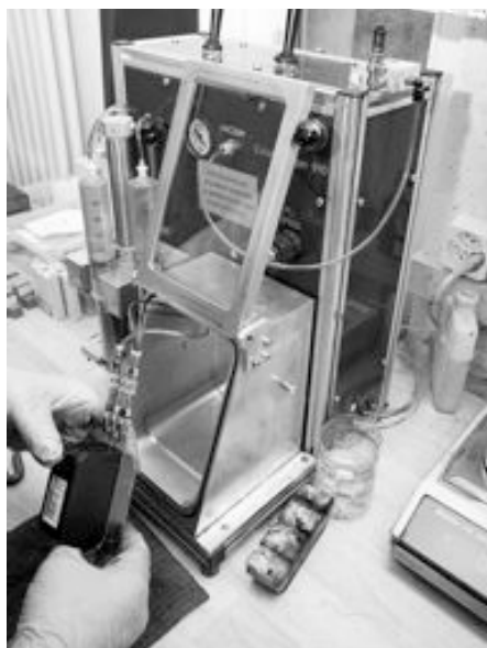
Reconditionnement des cartouches à l'atelier Saint-Hubert: remplissage (à gauche) et test des cartouches (à droite).
