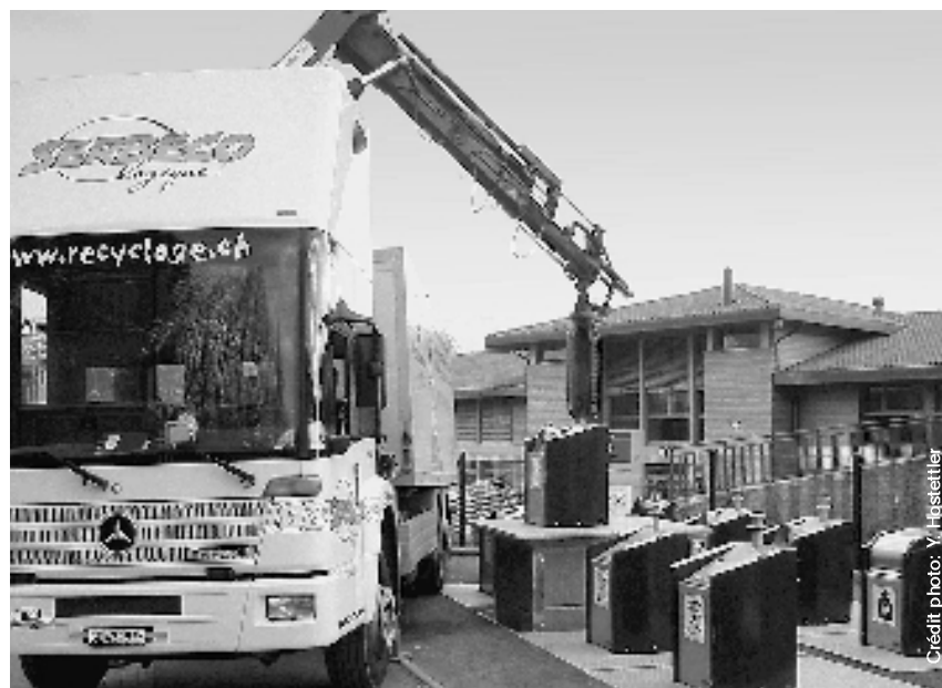
Véhicule développé par Serbeco: la cabine surélevée permet au chauffeur-technicien de piloter la grue, destinée à la vidange des conteneurs-terriers dans la benne 25 m 3 à compartiments, ceci en toute sécurité.
