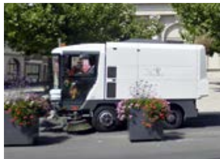
Les balayeuses sont gourmandes en diesel (6 l/h). Un logiciel permettra peut-être bientôt d'optimiser leurs parcours.
